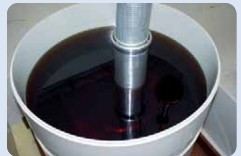
Durchführung der TE-Prüfung unter Öl (Shell Diala D) Testing of PD under oil (Shell Diala D)
