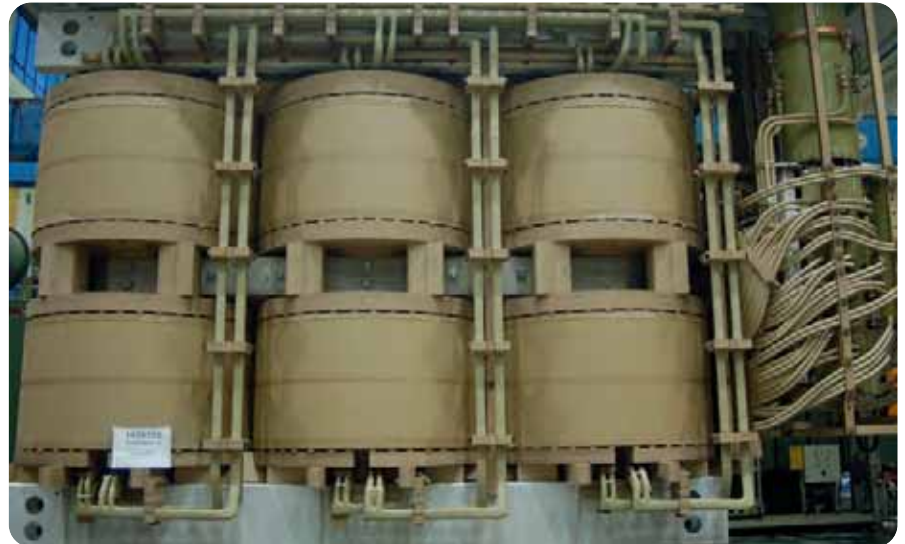
Leistungstransformator mit Druckringen aus Lignostone® Transformerwood® MX/2-E3 Hybrid
