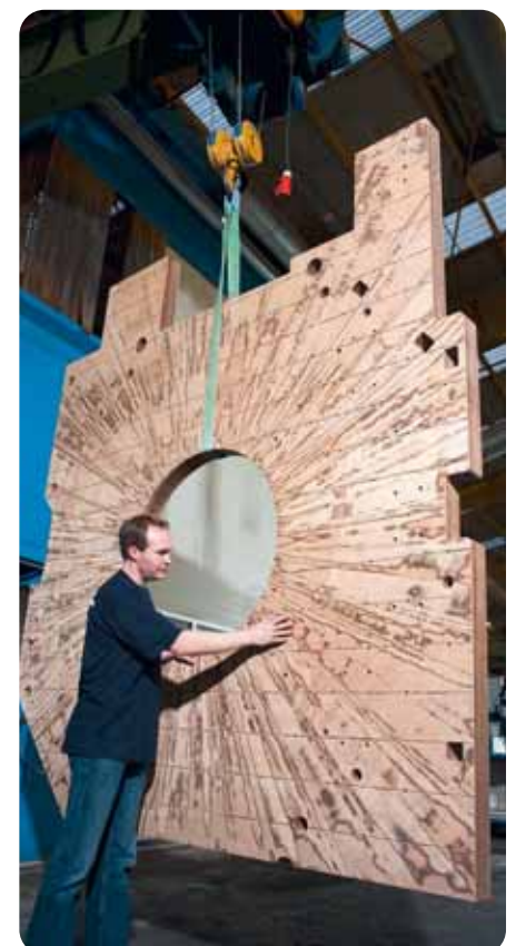
Tangential geschichteter Druckring Tangential laminated coil clamping ring (MX/2-E3, 1,300 kg, 2900 x 2590 x 100 mm)
