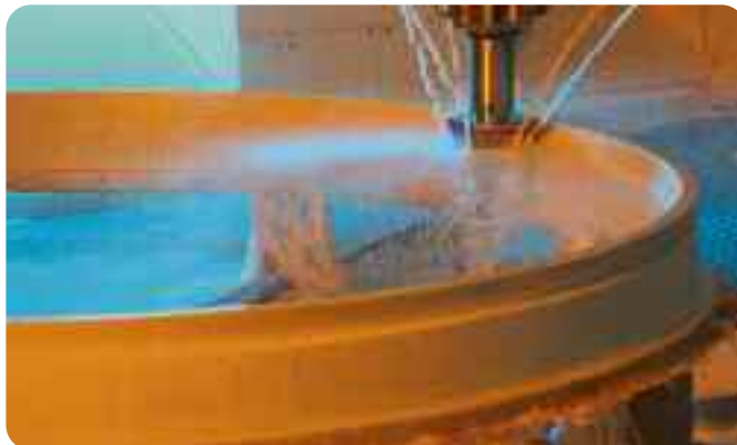
Mecanizando un anillo de soporte Durostone®
